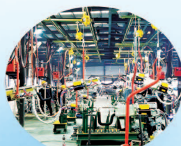
机器人装配汽车主体
